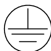
3872 – Marquage de mise à la terre. Le marquage de mise à la terre sur le dessin (côté raccord de l'appareil ou côté de l'appareil sur lequel se trouve le boîtier à bornes) indique le point de mise à la terre pour la prise de terre fournie par le client. Les liaisons de mise à la terre sur l'appareil lui-même sont également marquées par cet autocollant (elles ne figurent pas sur le dessin).
